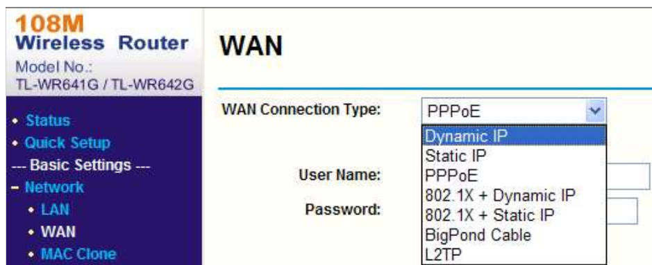
Rysunek A.2.1 Wybór typu połączenia sieci WAN
